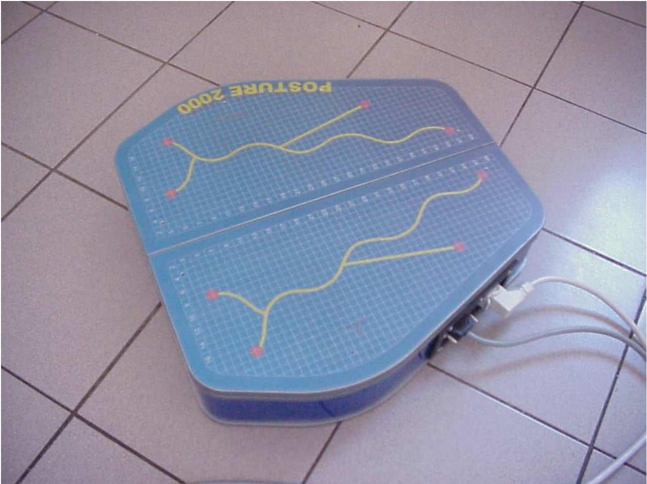
PEDANA POSTUROSTABILOMETRICA POSTURE2000 Nel corpo inferiore è installato il dispositivo vibrante.
